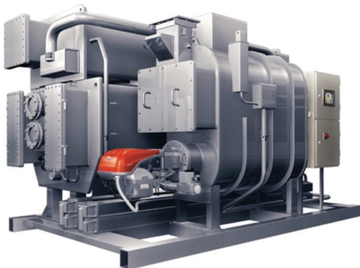
Rys. 8. Bromolitowy, dwustopniowy i dwuefektowy, absorpcyjny agregat chłodniczy zasilany wbudowanym palnikiem
